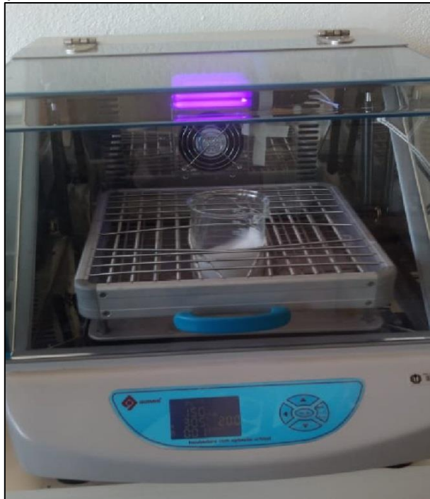
Figura 9 - Reator de bancada utilizado para os tratamentos fotocatalíticos.
