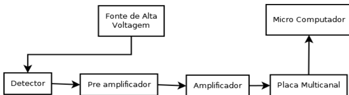
Figura 4.1: Configuração dos componentes eletrônicos que compõem o sistema de detecção.
