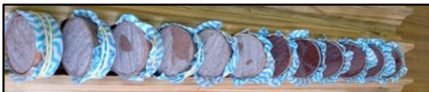
Figura 30 – Preparação dos corpos de prova – solo de Mandaguaçu.
