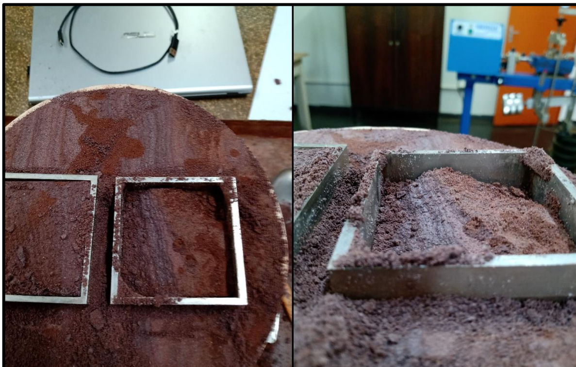
Figura 66 – Detalhe da amostra indeformada do solo de Mandaguaçu.
