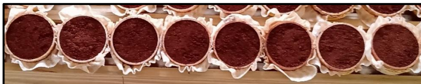
Figura 29 – Preparação dos corpos de prova – solo de Londrina.
