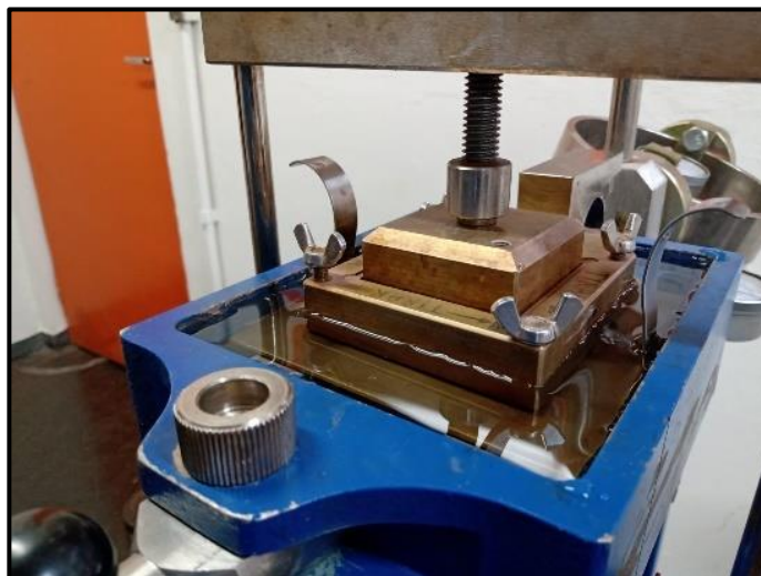
Figura 34 – Corpo de prova inundado.
