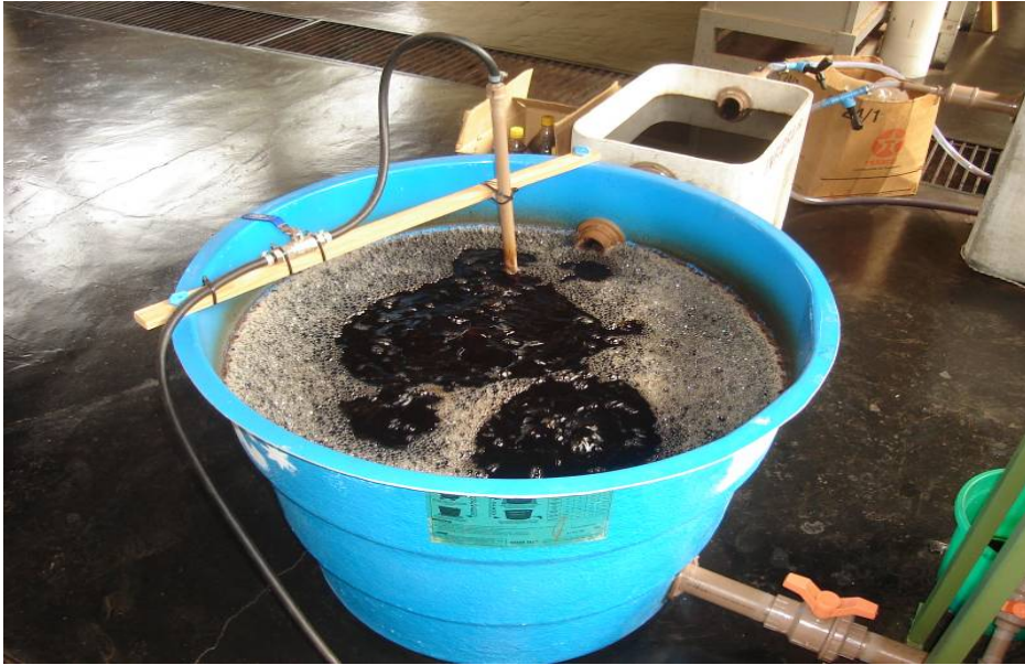
Figura 9 - Reator em fase aeróbia.
