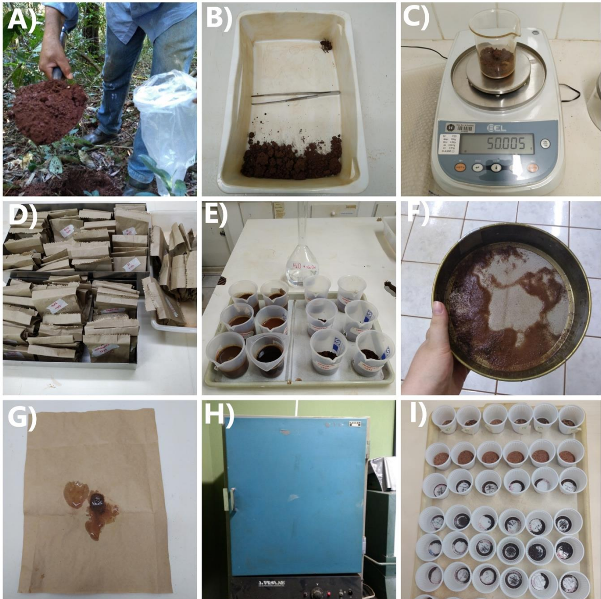
Figura 13- Etapas para a análise granulométrica dos solos dos 12 fragmentos florestais inseridos no sítio de Pesquisas Ecológicas de Longa Duração “Mata Atlântica do Norte do Paraná”, localizados no norte do estado do Paraná, Brasil. A) coleta de solo; B) triagem do solo; C) balança de precisão para pesagem da amostra de solo; D) amostra de solo triada e pesada; E) fração de solo em solução ( H_2O + NaOH ), por 48 horas; F) material em peneira de 0,125 mm utilizada para lavagem em água corrente; G) papel kraft com as partículas de solo para secagem em estufa; H) estufa utilizada para secagem do material por 24 horas; I) amostras acomodadas em copos plásticos de massa conhecida utilizados para a pesagem final.
