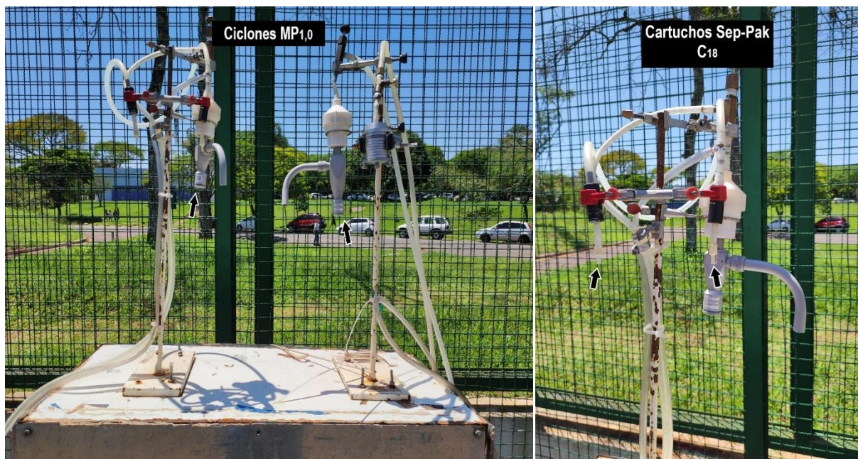
Figura 4 – Ciclones e cartuchos posicionados e instalados no local de amostragem.
