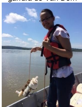
Figura 12 - Foto de amostragem utilizando a garrafa de Van Dorn
