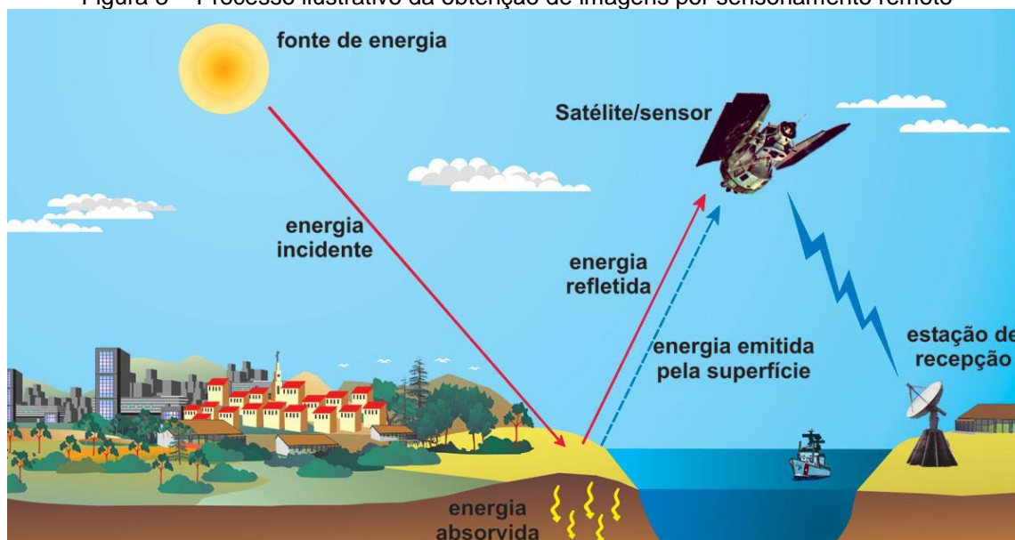
Figura 3 - Processo ilustrativo da obtenção de imagens por sensoriamento remoto
