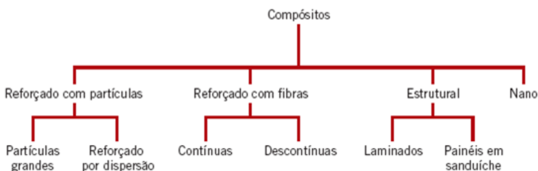
Figura 2 – Esquema de classificação dos compósitos.
