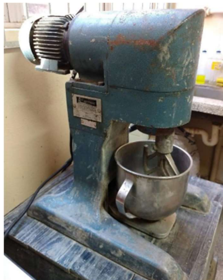
Figura 45 - Misturador planetário utilizado para confecção das misturas de argamassa
