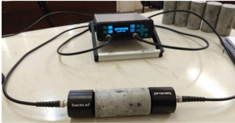
Figura 49 - Aparelho de ultrassom utilizado no ensaio de módulo de elasticidade dinâmico
