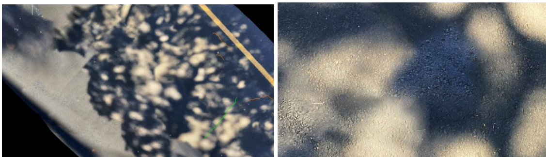
Figura 5.6 – Sombras na representação do pavimento no ortomosaico
