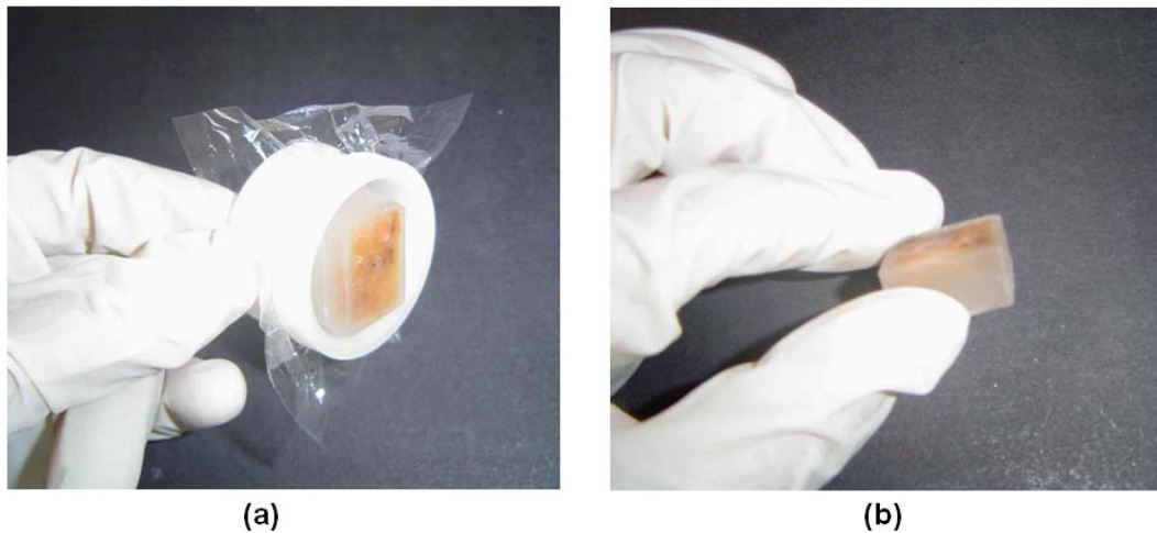
Figura 28 - Em (a) a amostra padronizada no porta amostra, em (b) detalhe da padronização da amostra antes dos cortes com micrótopo.
