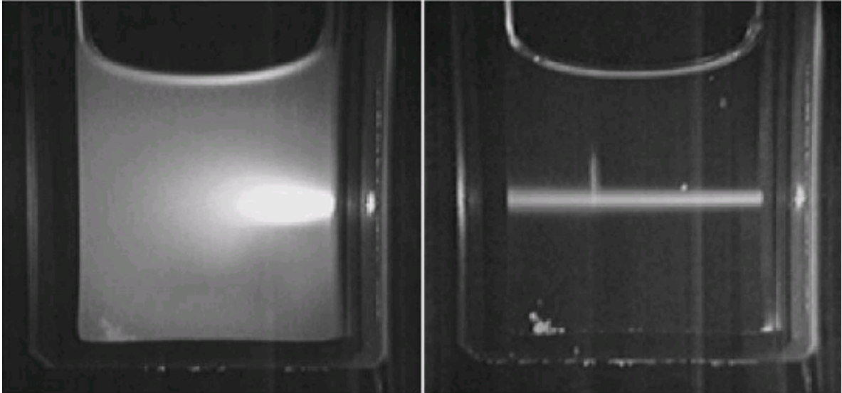
Figura 58 – Fotos de uma TNI, da esquerda para à direita, com o aumento da temperatura. Observa-se que na fase Nemática o Cristal Líquido apresenta o fenômeno da opalescência, que é o espalhamento da luz. A fase nemática tem aparência enevoada. Neste caso a temperatura é de T=27,1^{\circ}\text{C} na Fase Nemática e T=28,6^{\circ}\text{C} na Fase Isotrópica
