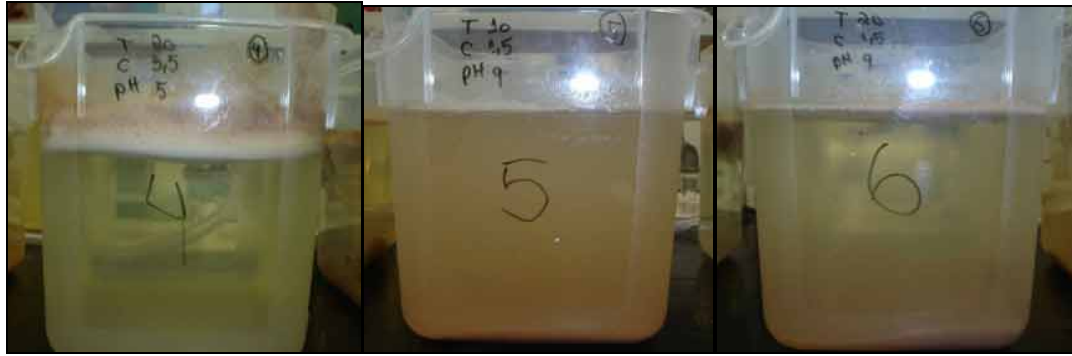
Figura 12 – Amostras do efluente após tratamento por EC dos experimentos 4 (pH 5; 3,5 A; 20 min.); 5 (pH 9; 1,5 A; 10 min.); 6 (pH 9; 1,5 A; 20 min.).
