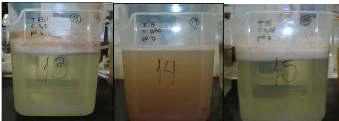
Figura 15 – Amostras do efluente após tratamento por EC dos experimentos 13 (pH 7; 2,5 A; 23,4 min.); 14 (pH 7; 0,82 A; 15 min.); 15 (pH 7; 4,18 A; 15 min.).
