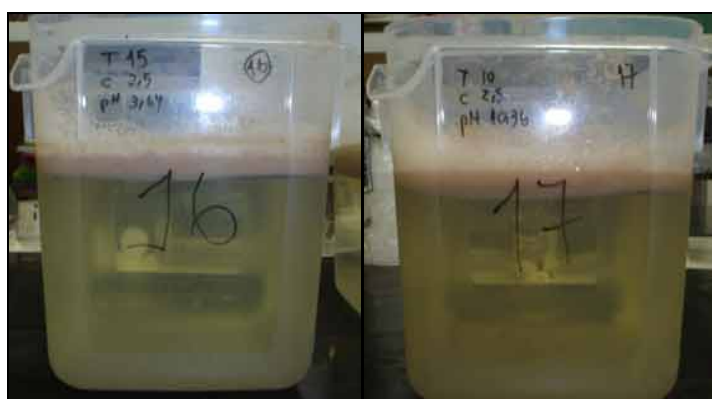
Figura 16 – Amostras do efluente após tratamento por EC dos experimentos 16 (pH 3,64; 2,5 A; 15 min.); 17 (pH 10,36; 2,5 A; 15 min.).
