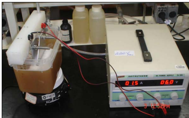
Figura 6 – Sistema eletroquímico em funcionamento, constituído pela fonte de corrente elétrica, eletrodos de alumínio, agitador magnético e efluente de lavagem de carros.
