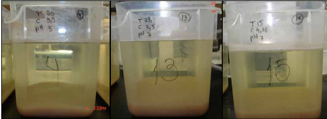
Figura 17 – Efluente de lavagem de carro após EC, agitação e correção do pH: 4 (pH 5; 3,5 A; 20 min.); 13 (pH 7; 2,5 A; 23,4 min.) e 15 (pH 7; 4,18 A; 15 min.).
