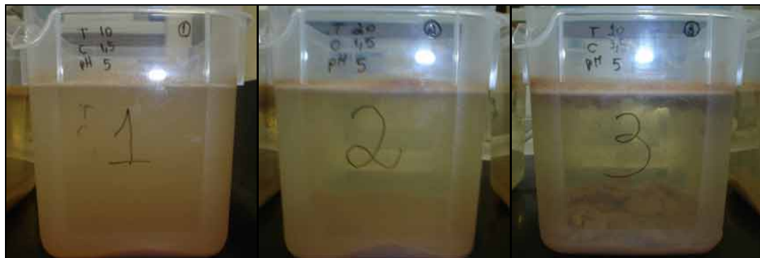
Figura 11 – Amostras do efluente após tratamento por EC dos experimentos 1 (pH 5; 1,5 A; 10 min.); 2 (pH= 5; 1,5 A; 20 min.); 3 (pH 5; 3,5 A; 10 min.)
