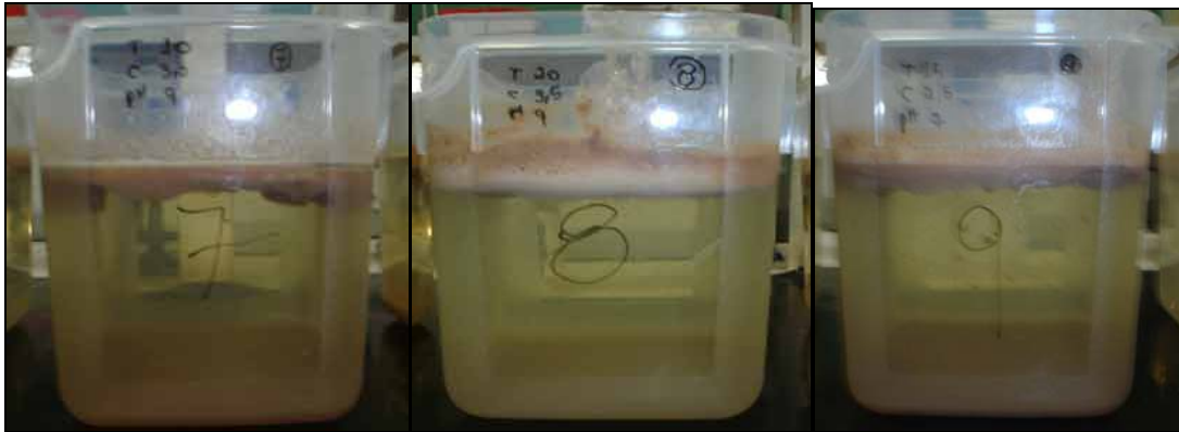
Figura 13 – Amostras do efluente após tratamento por EC dos experimentos 7 (pH 9; 3,5 A; 10 min.); 8 (pH 9; 3,5 A; 20 min.); 9 (pH 7; 2,5 A; 15 min.).
