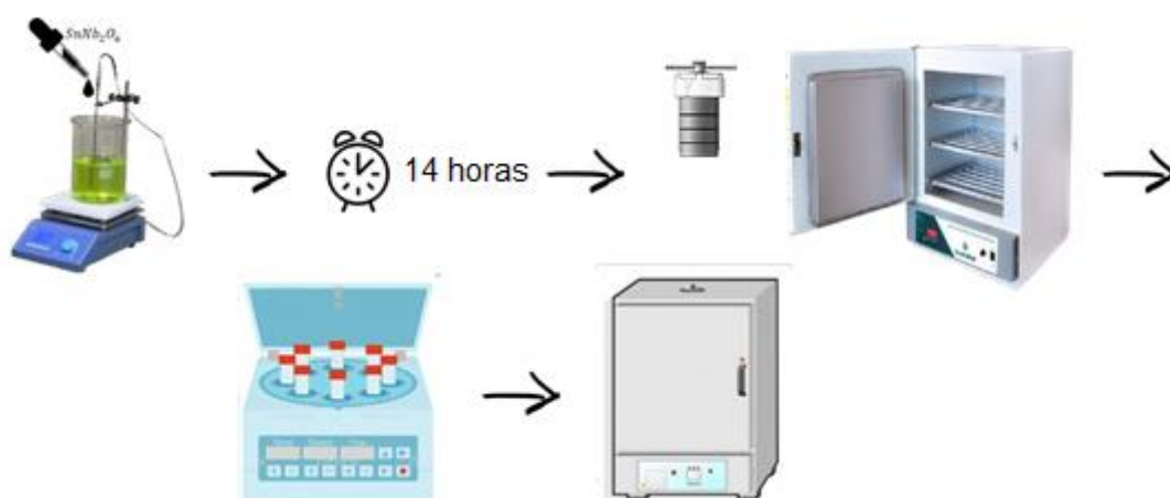
Figura 10 b: Representação esquemática da segunda parte da síntese do SNO/CN
