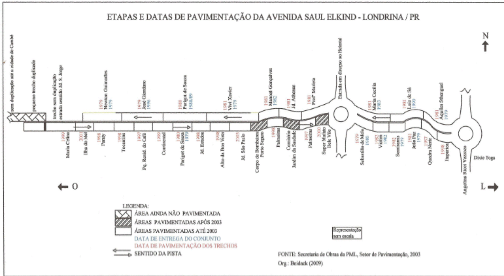
Figura 2 – Etapas e Datas de Pavimentação da Avenida Saul Elkind – Londrina / PR. Fonte: Santos (2004). Org.: Beidack (2009)
