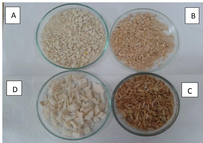
Figura 11 - Substratos farelo de soja (a), farelo de milho (b), casca de arroz (c) e bagaço de cana-de-açúcar (d) utilizados na FES
