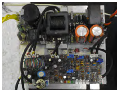
Figura 3.8 – Fotografia do carregador e de seu controle.
