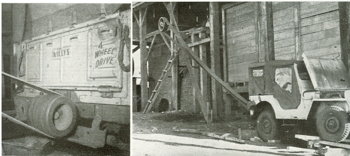
Figura 34 – Jipe sendo usado como força motriz para secagem do café
