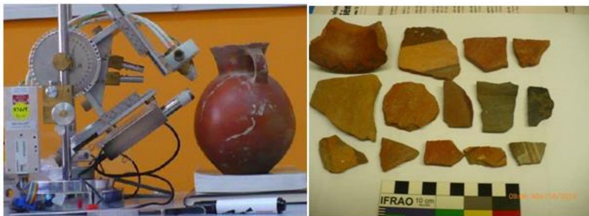
Figura 5.3 - Lado esquerdo: Equipamento portátil fazendo medidas de espectros de XRF de um dos vasos do sitio arqueológico de Achocalla. Lado direito: Quatorze fragmentos do sitio arqueológico de Achocalla fornecidos pelo Laboratório de Lítica – Universidad Mayor de San Andres.
