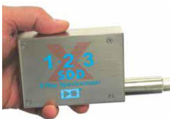
Figura 5.7 - Detector Si-Drift e pré-amplificador modelo X-123SDD. Fonte Moxtec Inc. 2016
