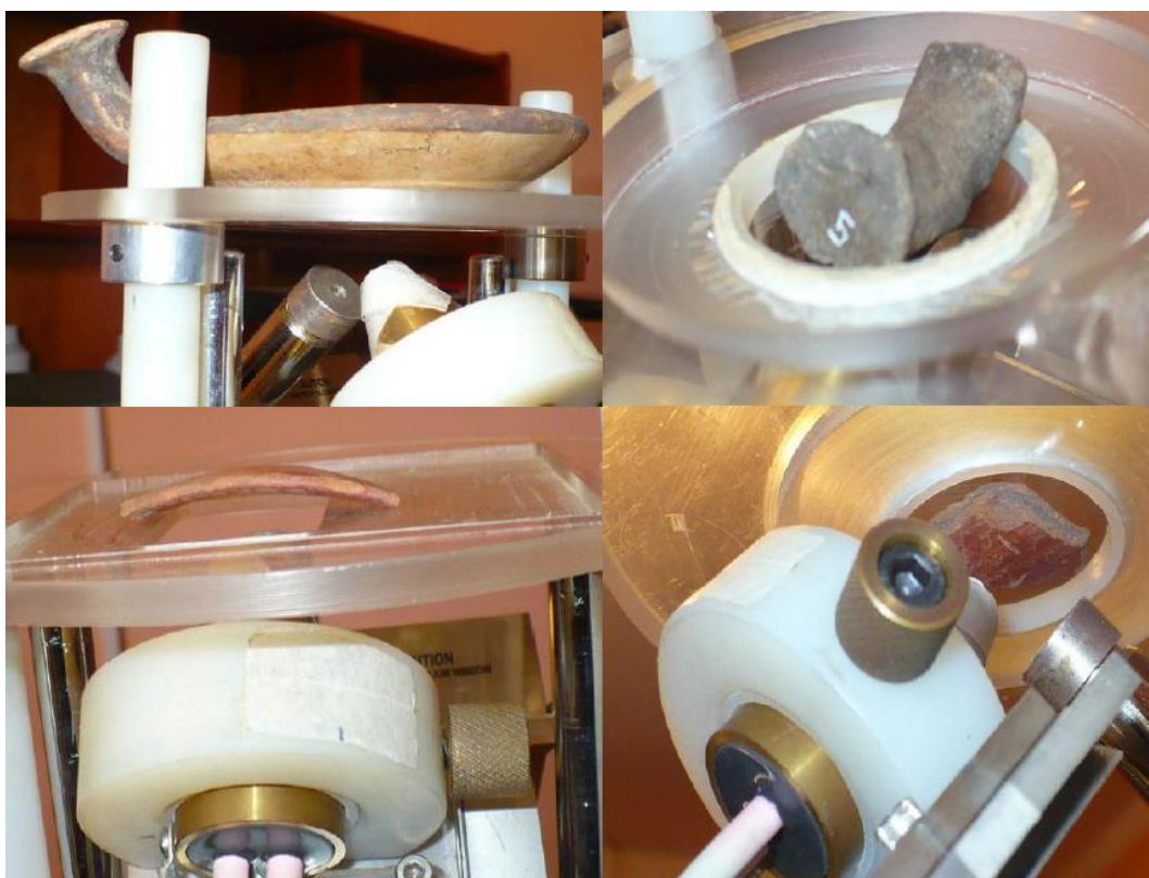
Figura 5.2 - Equipamento portátil adquirindo medidas in situ de espectros de XRF de quatro fragmentos cerâmicos pertencentes ao Museu de Tiwanaku.
