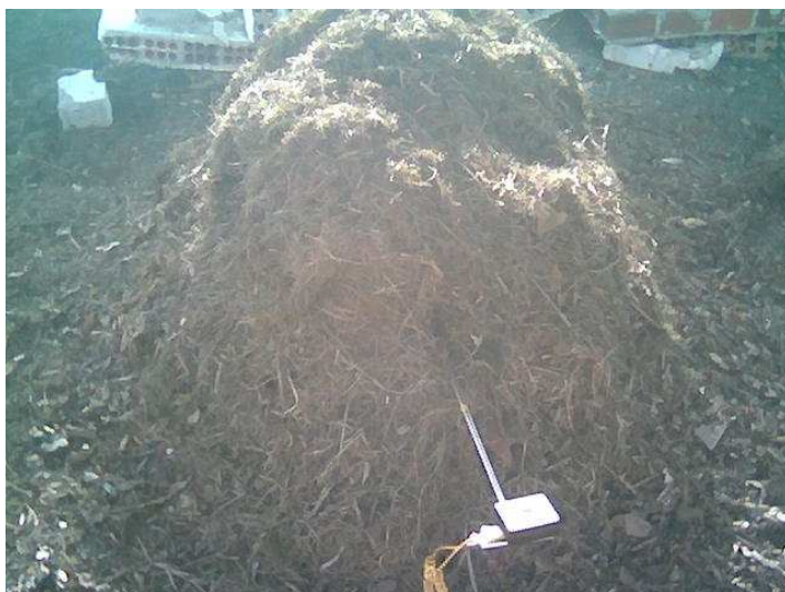
Ilustração 4 – Termômetro digital com haste metálica introduzida na leira.
