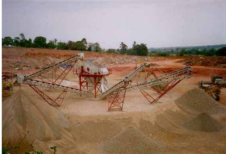
FIGURA 8 – Usina de reciclagem, responsável pelo processo de britagem do RCD.
