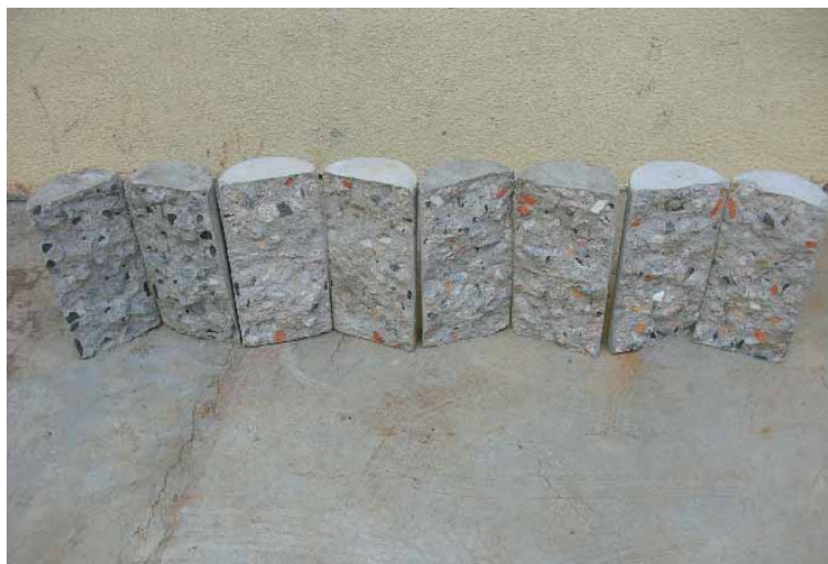
FIGURA 29 – Detalhes dos corpos de prova rompidos à tração.
