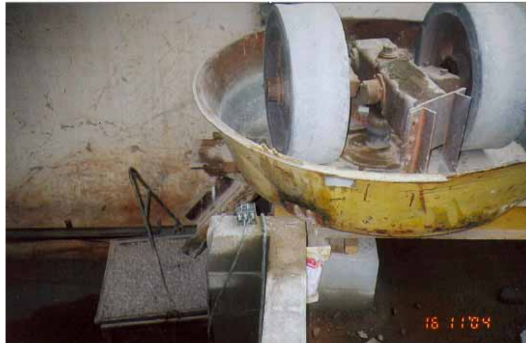
FIGURA 14 – Detalhes da moagem do RCD para a produção dos finos, que foram utilizados para a obtenção dos RCD com 5,85% de finos.
