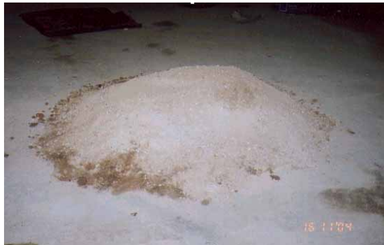
FIGURA 15 – Finos utilizados para a obtenção dos agregados de RCD com 5,85% de finos.
