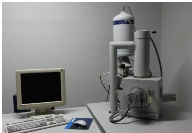
Figura 14 - Microscópio Eletrônico de Varredura usado obtenção de micrografias dos pós empregados no processo de ressíntese
