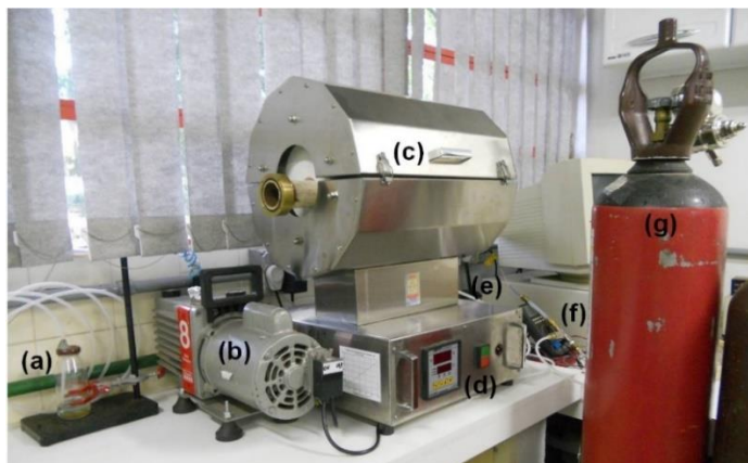
Figura 7 - Montagem experimental para o tratamento térmico das misturas de pós de material de catodos, composta por (a) borbulhador, (b) bomba de vácuo mecânica, (c) forno tubular, (d) programador digital do forno, (e) termopar, (f) válvula reguladora de gás e (g) cilindro de gás oxigênio
