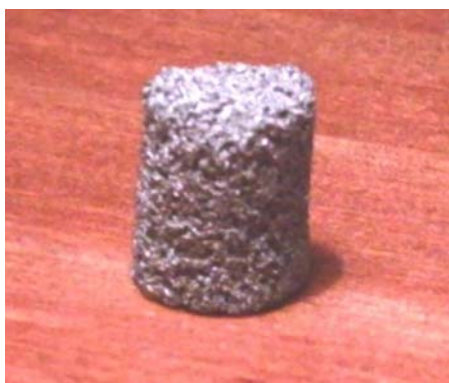
Figura 32 - Amostra sinterizada de Titânio.
