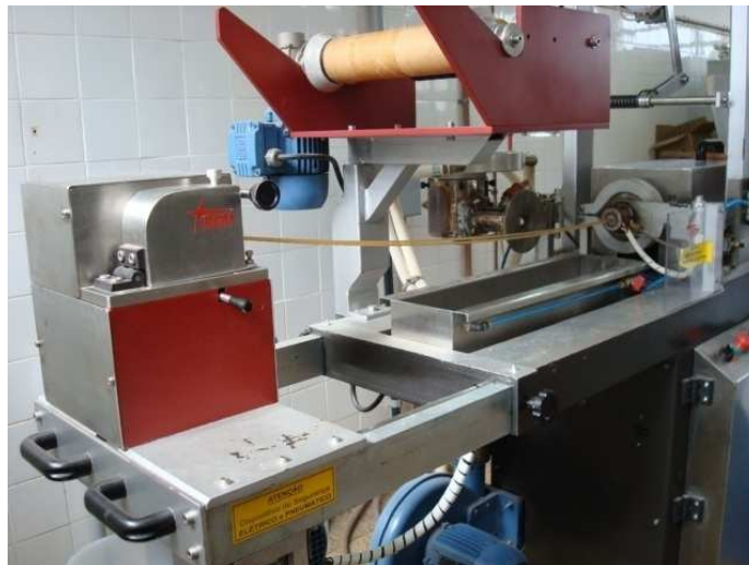
Figura 1. Extrusora utilizada para produção dos filmes.
