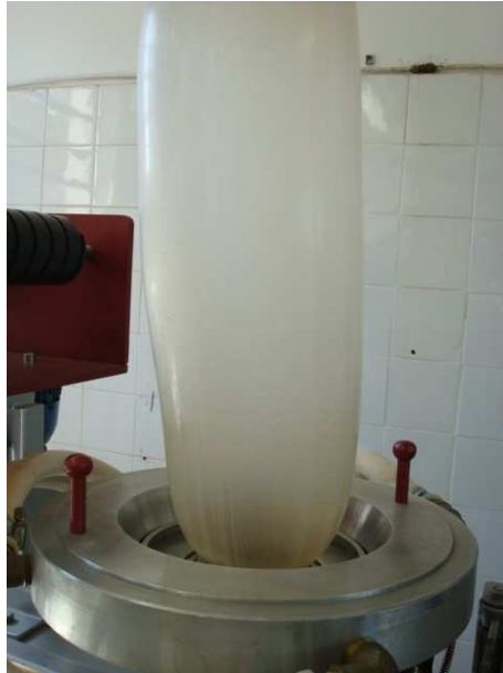
Figura 2. Produção de filme através da técnica de balão.
