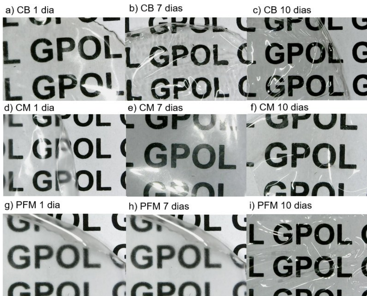
Figura 10 – Membranas obtidos por casting da solução de 5% das amostras de celulose em TFA.
