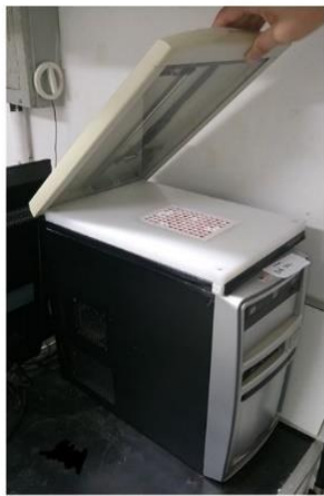
Aquisição das imagens da placa de poliestireno por scanner na posição invertida.
