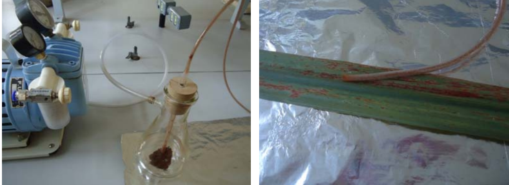
Figura 1 – Equipamento utilizado na extração dos urediniósporos de P. kuehnii em folhas de cana-de-açúcar: bomba de vácuo, coletor de vidro e mangueira para sucção dos urediniósporos.
