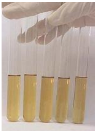
Figura 11 – Misturas de biocombustível com gasolina nas concentrações de 0, 2, 5, 10 e 20% v/v.
