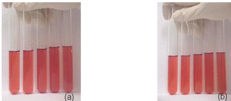
Figura 10 – Misturas de biocombustível com diesel comercial nas concentrações de 0,5; 1,0; 1,5 e 2,0 % v/v (da esquerda para direita); (a) sem tensoativo e (b) com 0,01 % de Span 80 e Tween 80.
