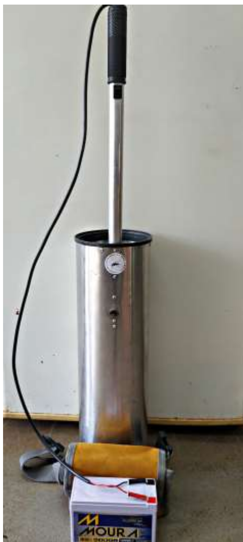
Fig. 6. Aspirador de Nasci otimizado para captura de mosquitos adultos. Fonte: o próprio autor.
