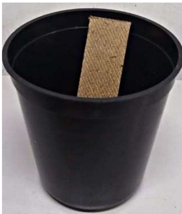
Fig. 5. Armadilha do tipo ovitrampa para captura de ovos de Aedes . Fonte: o próprio autor.
