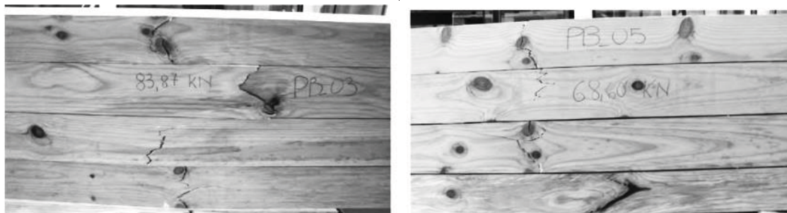
Figura 21 - Modo de falha do painel CLT em correspondência de nós (à esquerda) e ao alinhamento de nós (à direita).
