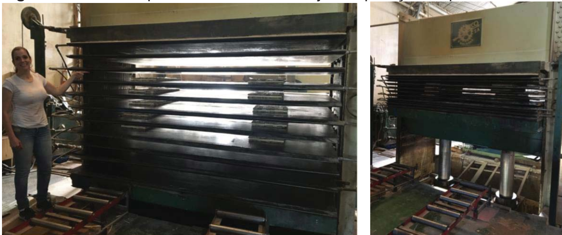
Figura 52 - Painéis posicionados nas bandejas e aplicação de pressão.
