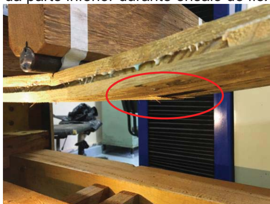
Figura 58 - Ruptura da parte inferior durante ensaio de flexão
