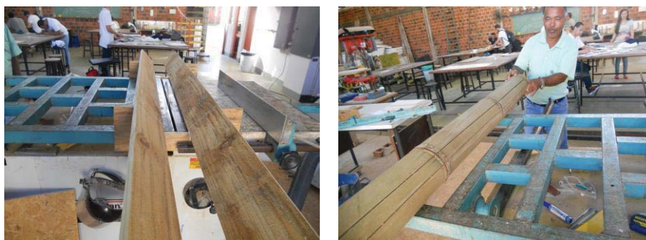
Figura 28 - Adaptação da serra circular para desdobro do bambu.
