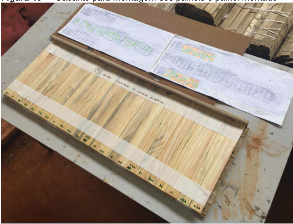
Figura 48 - Gabarito para montagem dos painéis e painel montado
