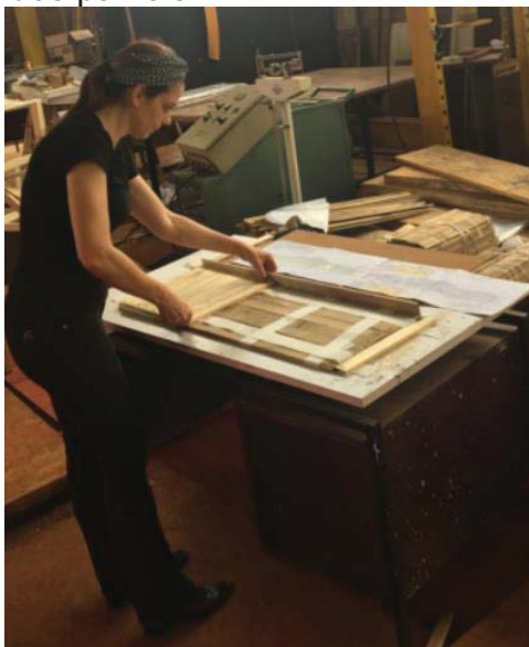
Figura 49 - Montagem dos painéis
