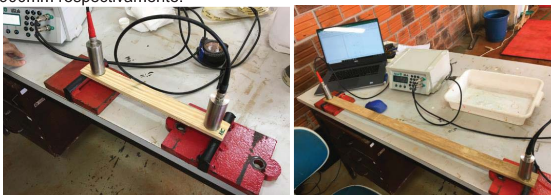
Figura 36 - Medição de ultrassom nas peças de pinus de 320mm e bambu de 900mm respectivamente.
