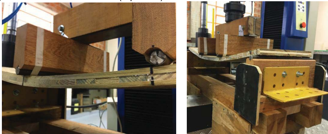
Figura 57 - ensaio de flexão (4 pontos)
