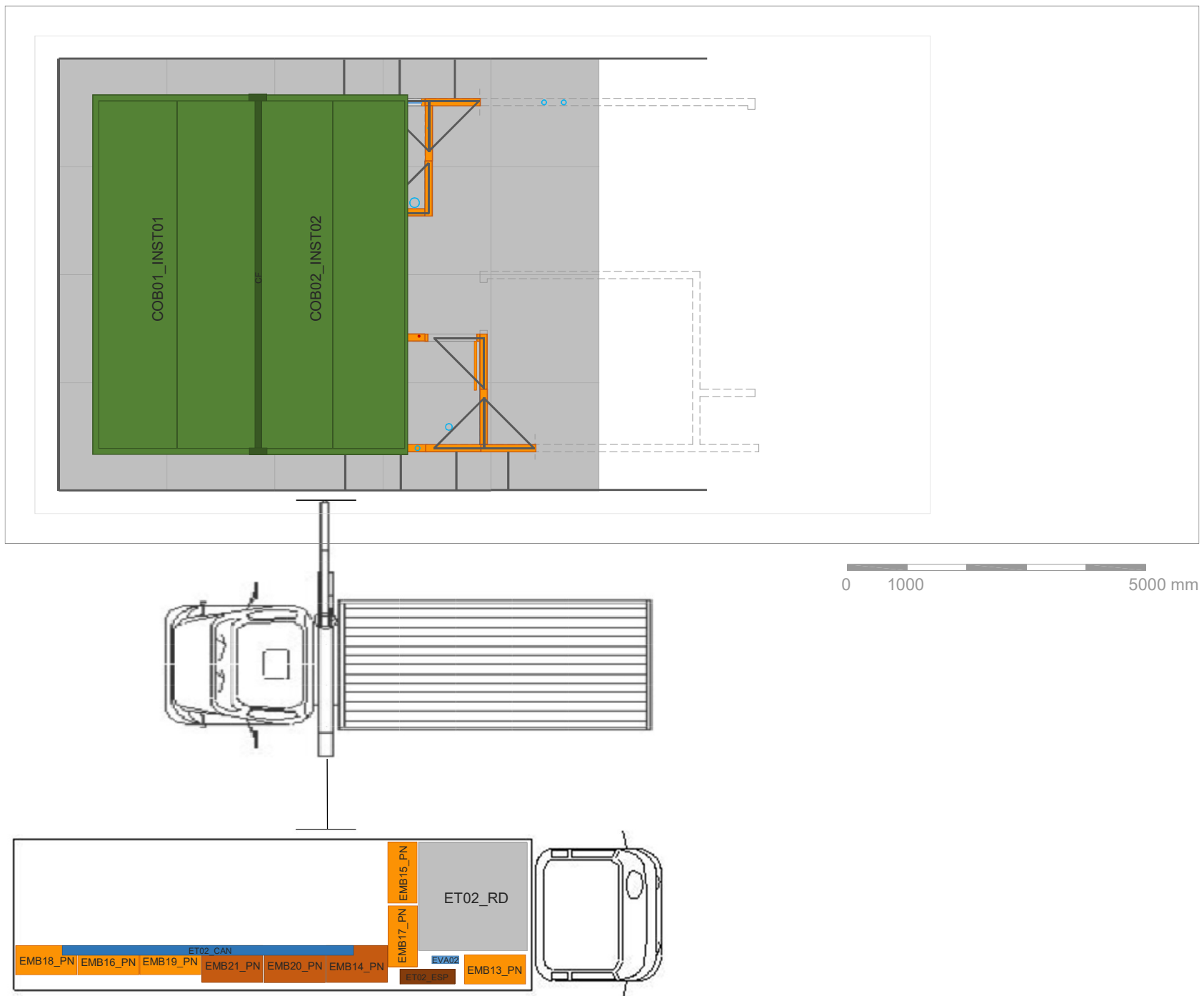
ETAPA 01 – CARGA 02: Cobertura e rodapés da primeira etapa montados
