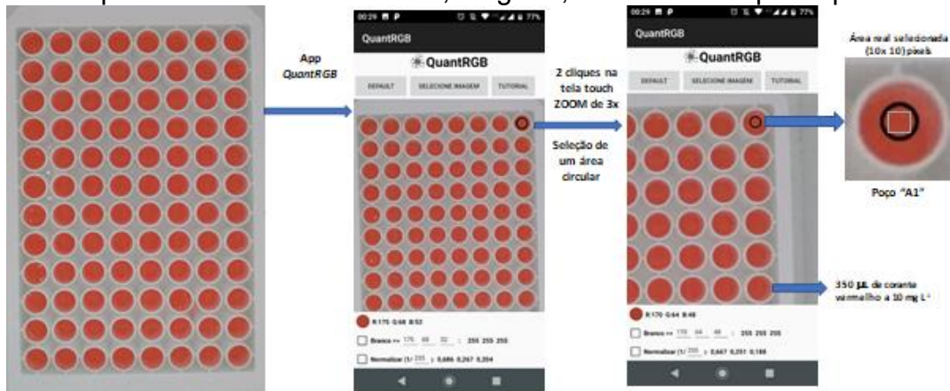
Figura 26. Imagem digital adquirida utilizando o Sistema II via câmera do smartphone Moto G, com resolução de 13 MP (4:3), da placa de 96 poços com volume amostral de 350 \mu L e corante vermelho a 10,0 mg L -1 , sendo tratada pelo aplicativo QuantRGB
