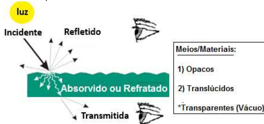
Figura 7. Fenômenos que podem ocorrer com a luz incidente e a forma com que a cor pode ser vista dependendo do material
