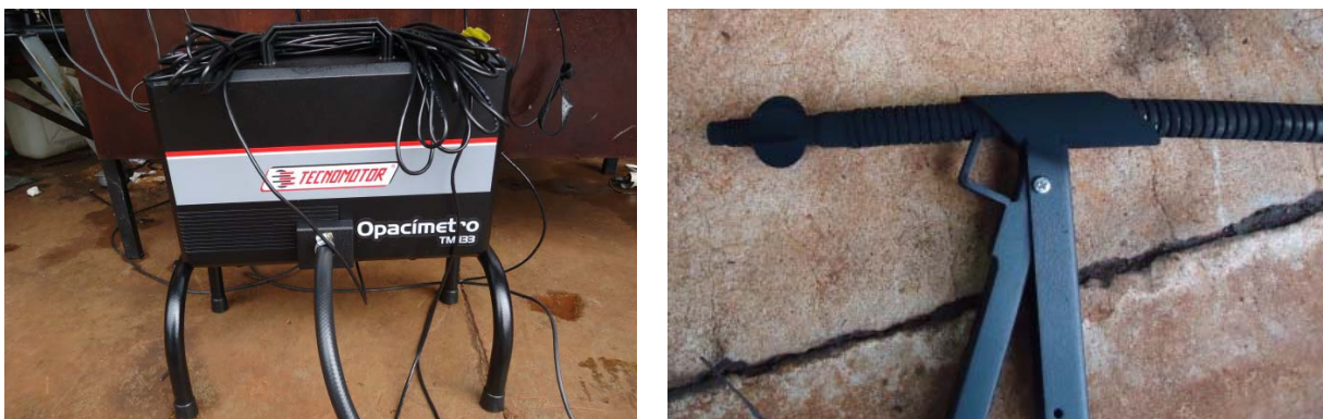
Figura 6 – Opacímetro (esquerda) e sonda para coleta da amostra de gases na saída do tubo de exaustão de gases (direita)
