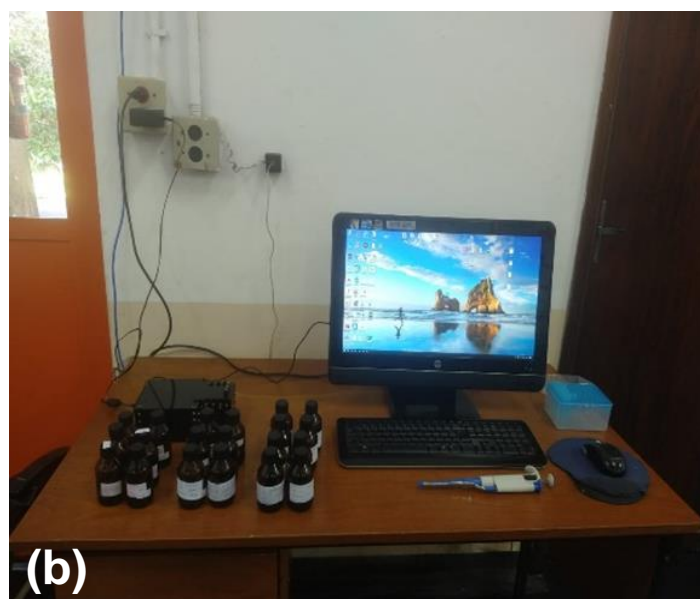
Figura 2 – (a) Espectrofotômetro NIR empregado, após inserção em uma caixa acrílica preta para proteção e suporte do equipamento. (b) Espectrofotômetro interfaceado a um microcomputador para aquisição dos espectros NIR.
