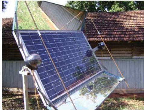
Figura 2.4 – Sensores LDR's instalados sobre a superfície do módulo fotovoltaico
