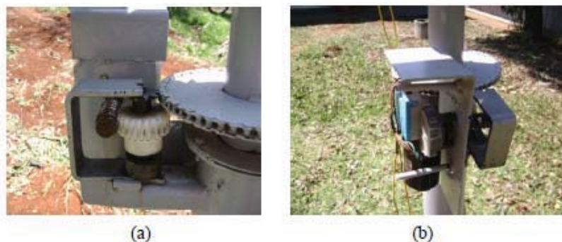
Figura 4.6 – acoplamento do motor para controlar o giro.
