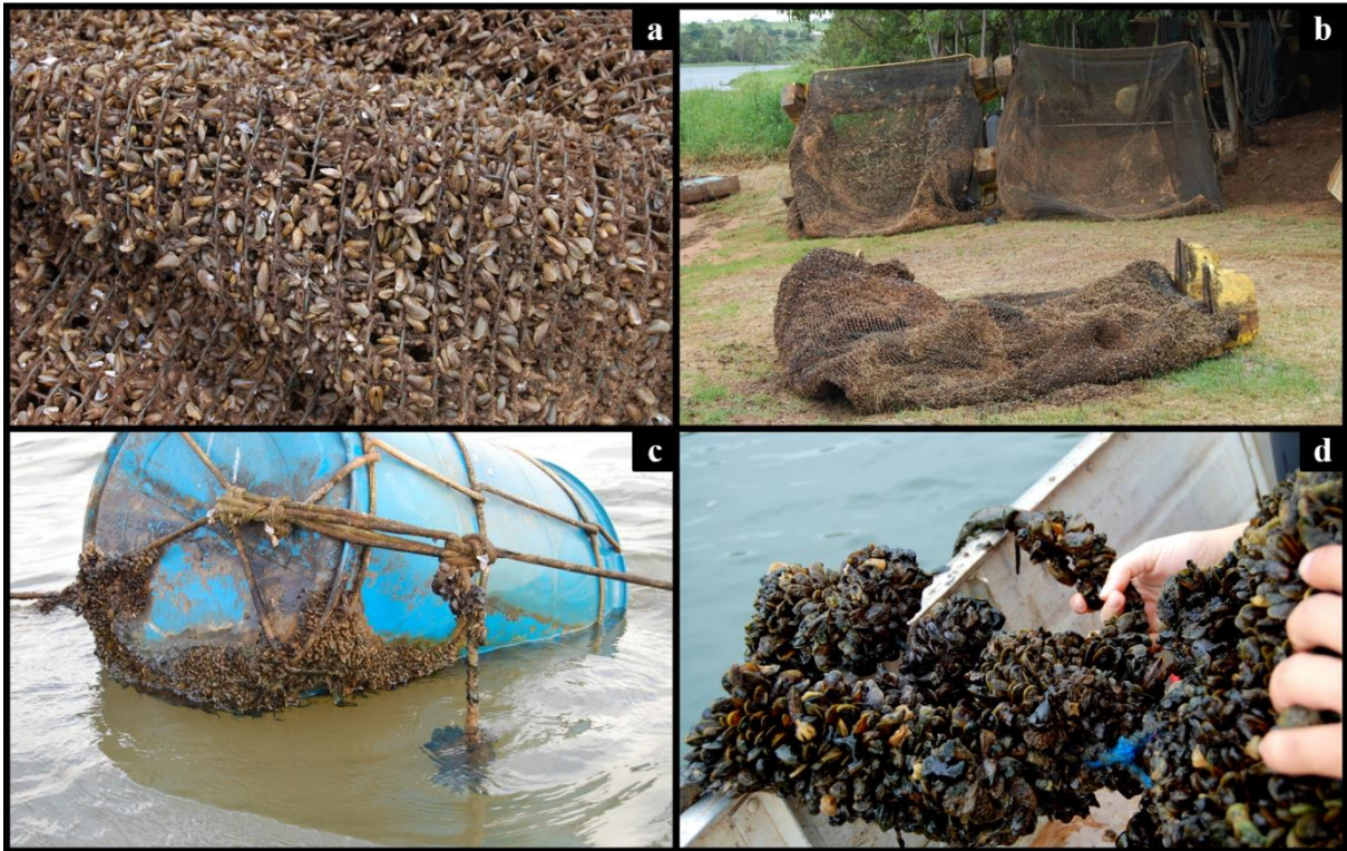
Figura 2 – Incrustação do Mexilhão dourado em componentes utilizados nas pisciculturas com criação em sistema tanques-rede: a. Oclusão das malhas dos tanques causada por incrustação do mexilhão; b. Vários tanques-rede com incrustação do mexilhão; c. Boias de demarcação com incrustações; d. Cordas com incrustação
