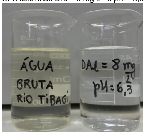
Figura 33 – Água do rio Tibagi bruta e após as etapas de coagulação, floculação e sedimentação – CFS utilizando DAI = 8 \text{ mg L}^{-1} e \text{pH} = 6,3
