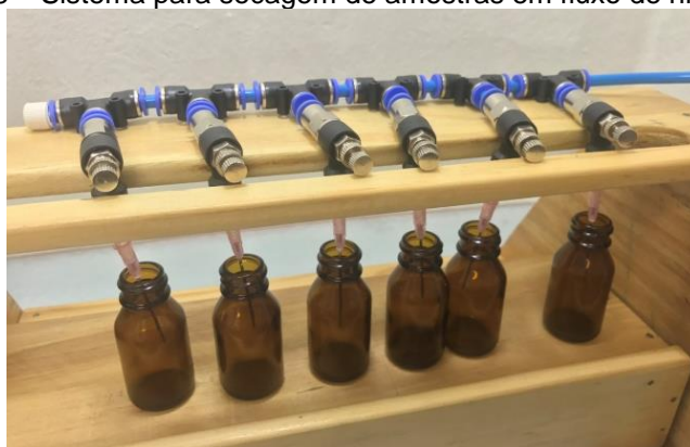
Figura 8 – Sistema para secagem de amostras em fluxo de nitrogênio
