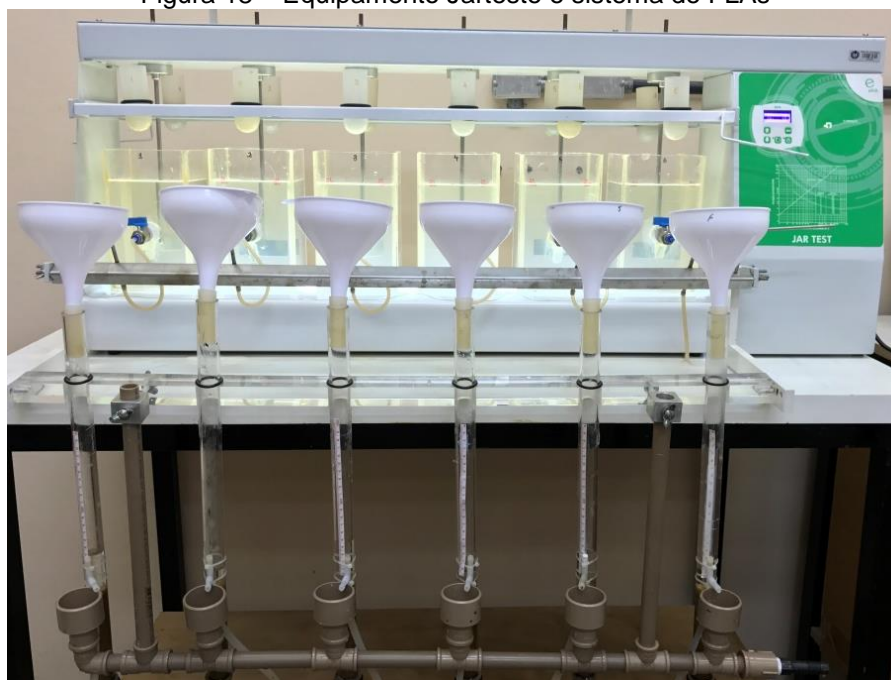
Figura 18 – Equipamento Jarreste e sistema de FLAs
