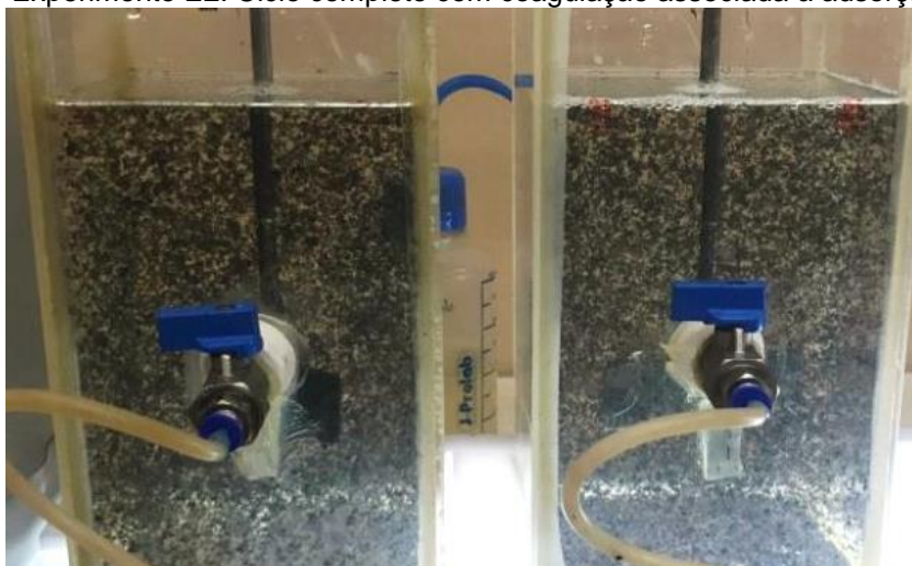
Figura 35 – Experimento E2: Ciclo completo com coagulação associada à adsorção em CAP5
