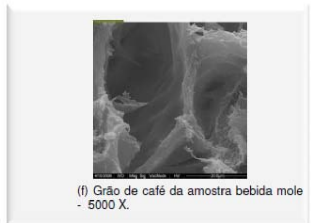
Figura 14 – Imagens do grão de café por microscopia eletrônica de varredura (MEV).
