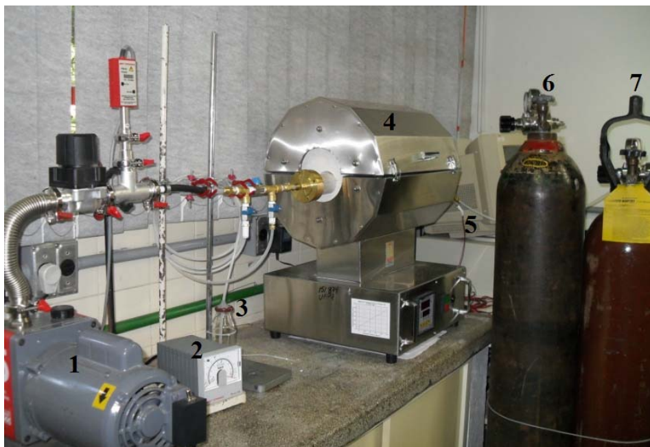
Figura 2-1 – Montagem experimental para o tratamento térmico. Onde (1) bomba de vácuo mecânica, (2) medidor de vácuo, (3) controlador de fluxo de gás, (4) forno, (5) fio do termopar, (6) e (7) cilindros de oxigênio e argônio, respectivamente.
