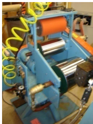
Figura 2.13 – Sistema de calandragem para formação de filmes planos ou laminados.
