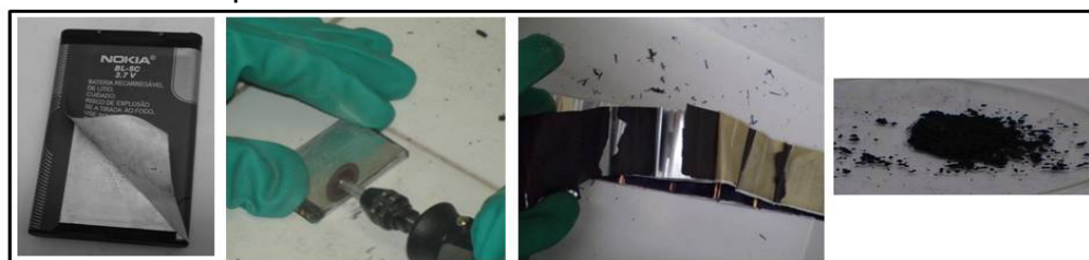
Figura 6 - Bateria de íon-lítio na etapa de desmonte individualizado até extração do catodo em pó.
