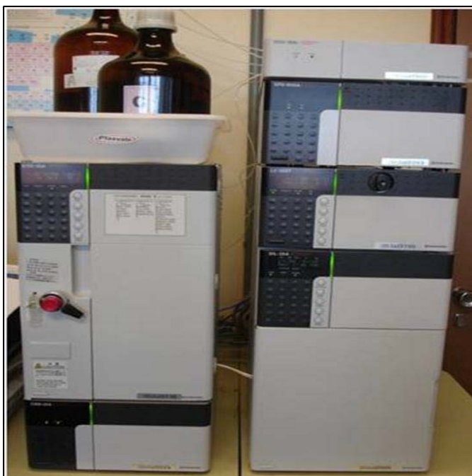
Figura 1 - Equipamento HPLC (High Performance Liquid Chromatography) utilizado para identificação e quantificação de compostos secundários de extratos vegetais obtidos da folha da soja.
