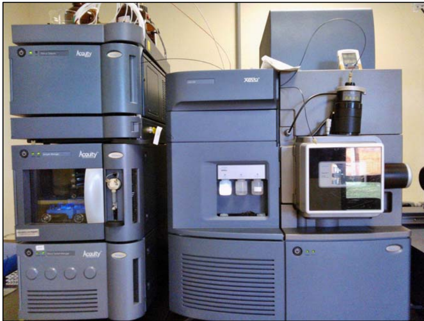
Figura 3 - Equipamento LC-MS/MS (Liquid Chromatography – Mass Spectrometry) utilizado para identificação e quantificação das agliconas obtidas do corpo do inseto.
