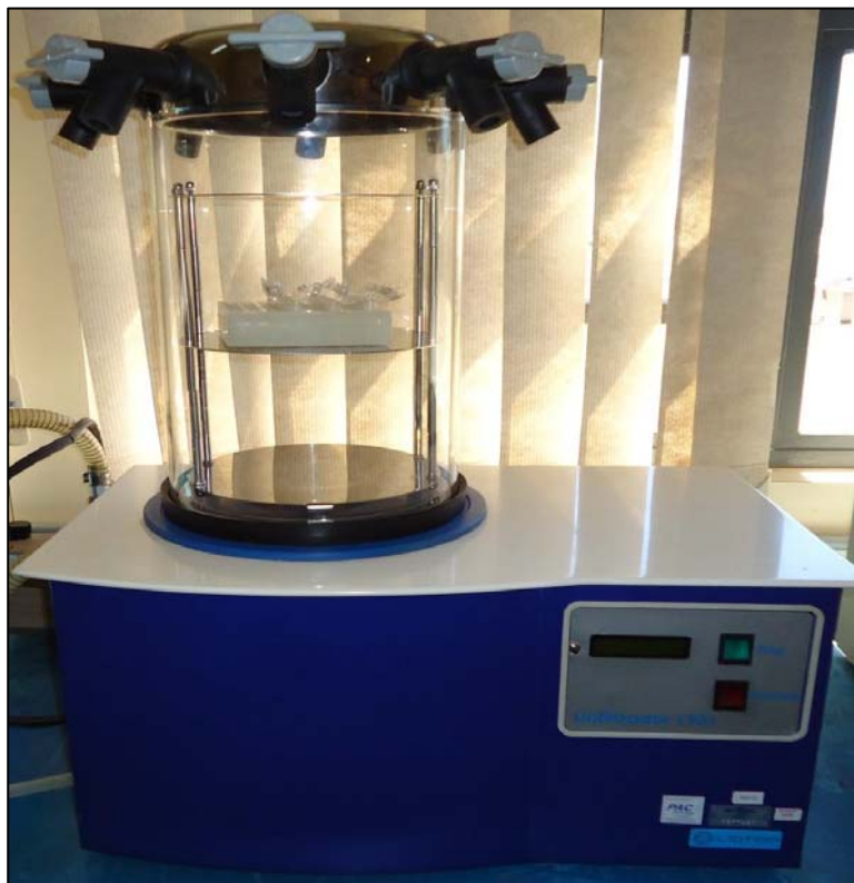
Figura 2 - Equipamento Liotop L101 utilizado para liofilizar o corpo do inseto.
