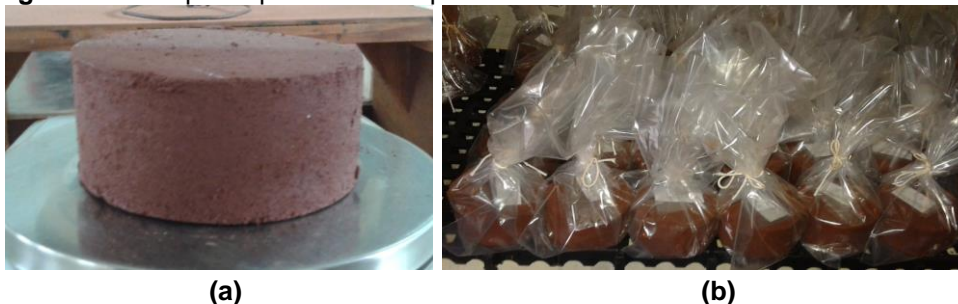
Figura 11 – Corpo de prova cortado para o ensaio de difusão
