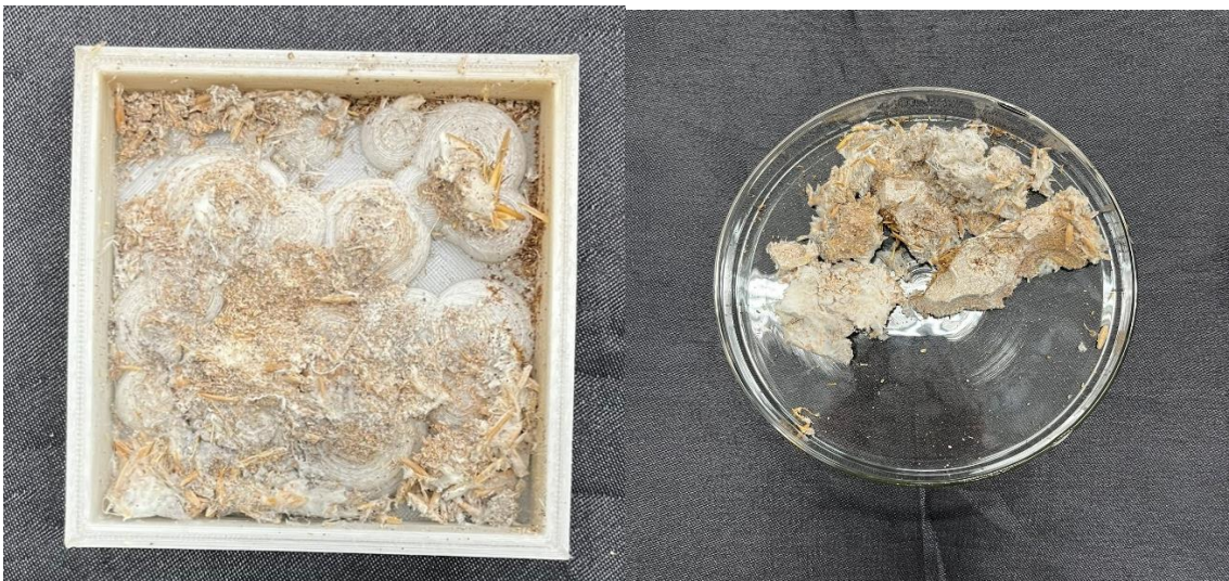
Figura 15: biomaterial formado utilizando o molde 2.
