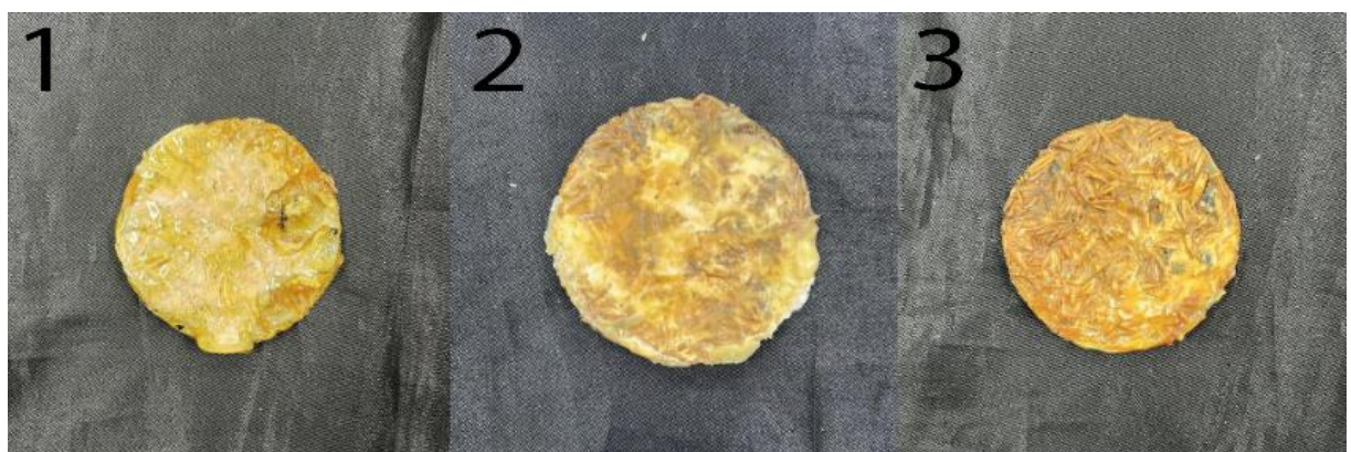
Figura 12: biomateriais testados com as diferentes resinas utilizando o pincel. Legenda: 1 – biomaterial com resina de breu; 2 – biomaterial com
