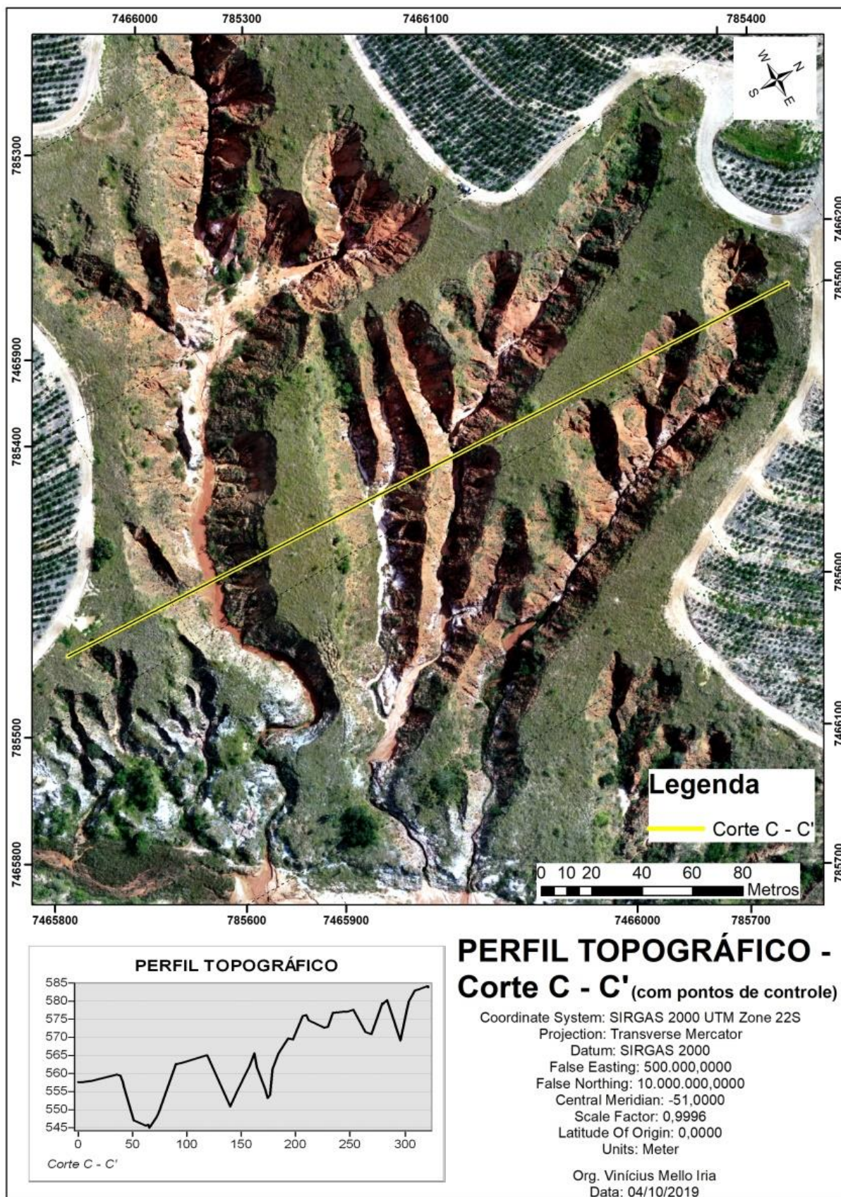
Figura 19: Mapa de perfil topográfico – Corte C – C' (com pontos de controle).
