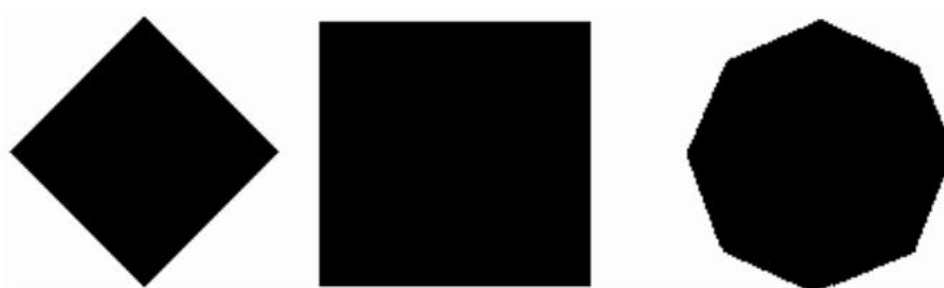
Figura 14 – Elementos estruturantes das métricas d_4 , d_8 e d_{3-4} . Extraída de (Imago - Manual Científico, 2002)
