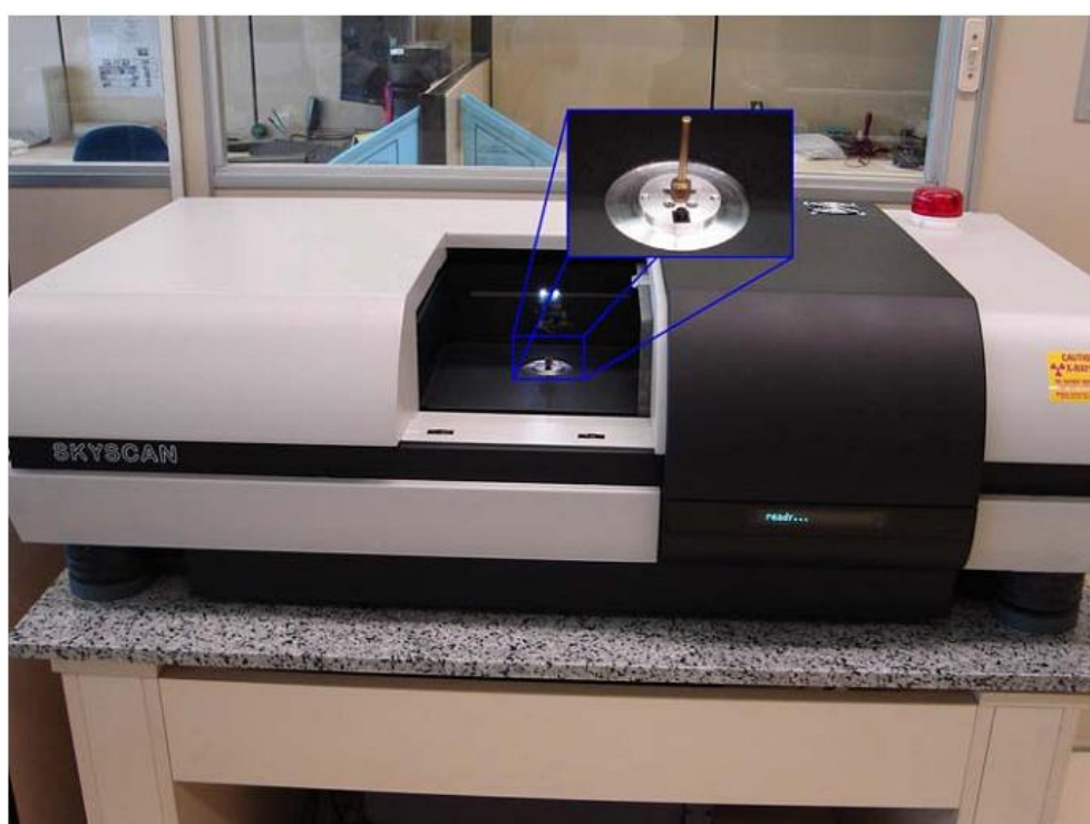
Figura 28 – Microtomógrafo Skyscan 1172, com suporte para amostra em detalhe. Extraída de Moreira (2006).
