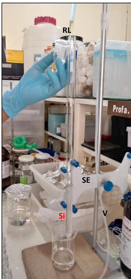
Figura 7. Cromatografia flash : (RL) extrato bruto dissolvido, (Si) sílica empacotada, (SE) solvente de eluição e (V) aplicação de vácuo
