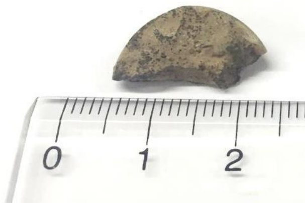
Figura 56 – Amostra de rocha arenítica contendo hematita.
