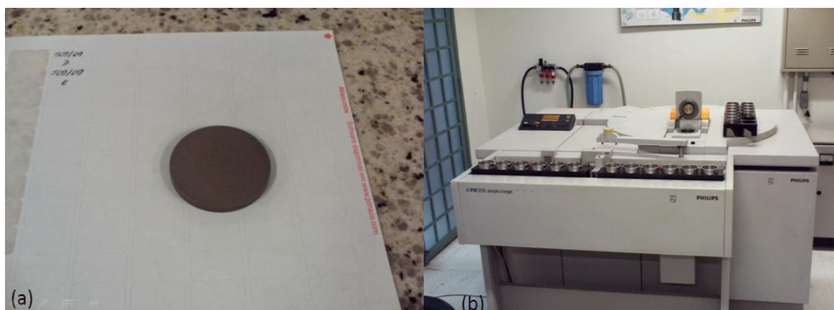
Figura 13 - (a) pastilha e (b) equipamento Philips PW 2400.
