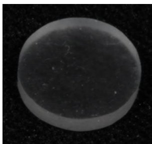
Disco usinado em acrílico utilizado como molde para confecção da matriz em silicone por condensação laboratorial.
