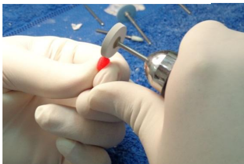
Regularização dos corpos de prova em resina acrílica.
