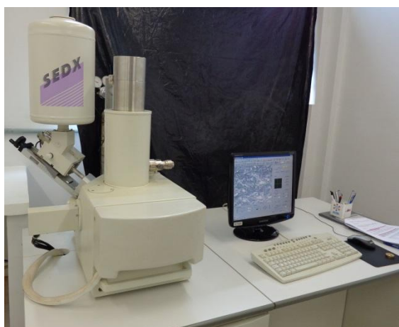
Obtenção das eletromicrografias através de Microscópio SS 550 (Shimadzu, Quioto, Japão).
