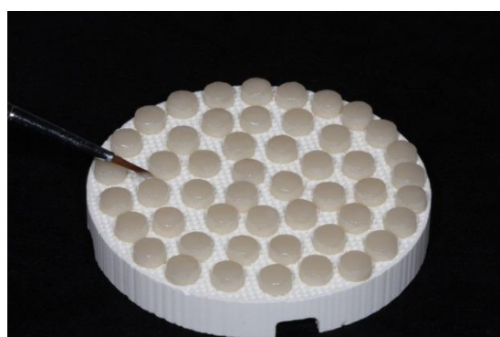
Aplicação da camada de glaze através de pincel sobre a superfície dos discos cerâmicos.
