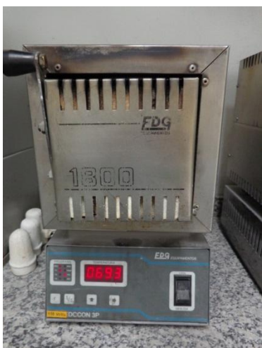
Evaporação da resina acrílica no forno Edgcon 3P (EDG Equipamentos, Brasil).
