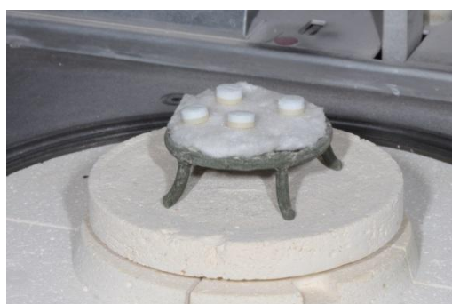
Discos cerâmicos com cerâmica de cobertura sobre manta refratária levados para queima ao forno Programat P500 (Ivoclar Vivadent, Liechtenstein).
