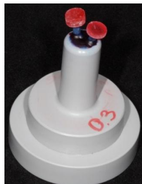
Montagem dos padrões em resina na base do anel de revestimento para inclusão no anel de revestimento.
