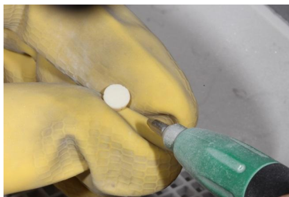
Jateamento da superfície com óxido de alumínio de 50µm (Bio Art, São Carlos, Brasil), sob pressão de 2,5bar, durante 10 segundos, à distância de 10mm.
