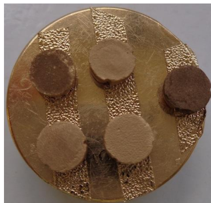
Amostras fixadas em stub e recobertas com ouro.
