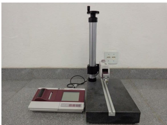
Aparelho utilizado para a leitura da rugosidade média das amostras (Surftest SJ 400, Mitutoyo America, EUA).
