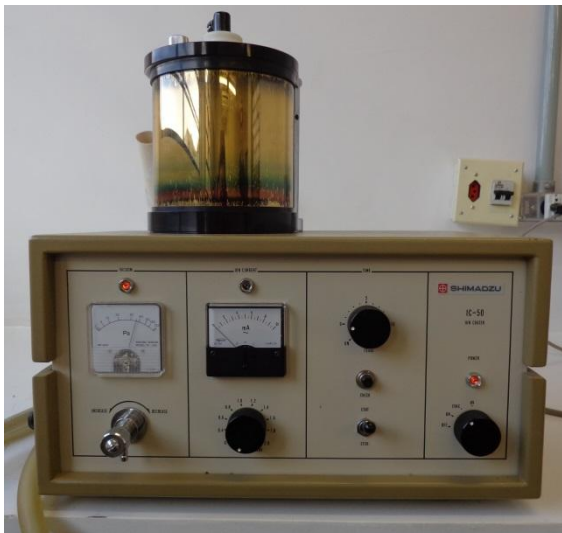
Recobrimento com ouro das amostras em metalizadora IC50 (Shimadzu, Quioto, Japão).
