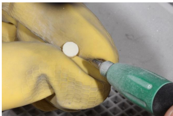
Jateamento da superfície com óxido de alumínio de 110µm (Defama, Porto Alegre, Brasil), sob pressão de 2,5bar, durante 10 segundos, à distância de 10mm.
