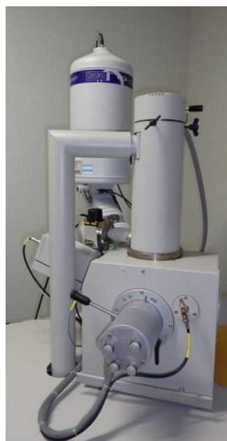
Obtenção das eletromicrografias através de Microscópio Quanta 200 (Fei, Oregon, EUA).
