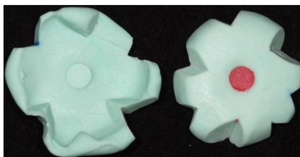
Matriz em silicone após a presa do material (resina acrílica).
